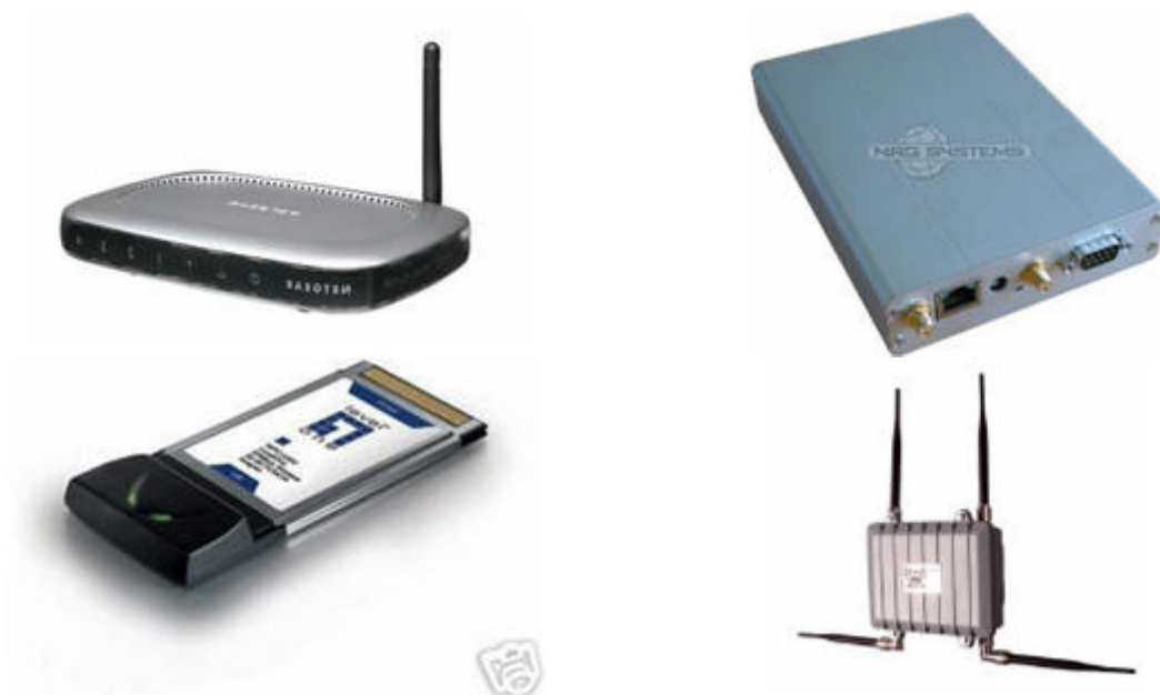
Abbildung 11: Vom BRN zur Zeit unterstützte Embedded Devices (Netgear 643u, WRAP Board, Atheros-based PCMCIA, Soekris Board).
