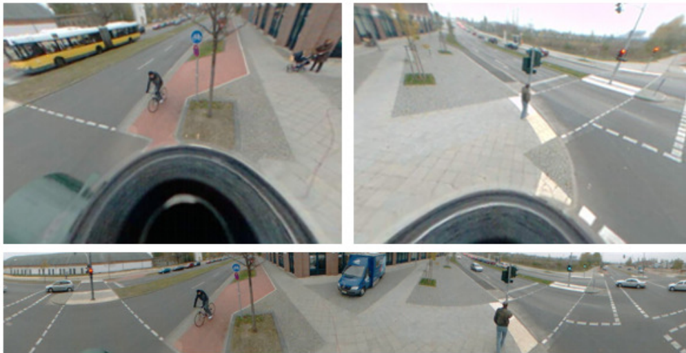
Abbildung 10: entzerrte Teilbilder (oben) und entzerrtes Panorama (unten)
