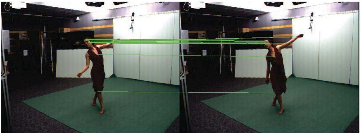
**Abbildung 5.15** Harris-Affine Detektor mit GLOH Deskriptor: 24 Matches werden gefunden, davon alle 24 korrekt.
