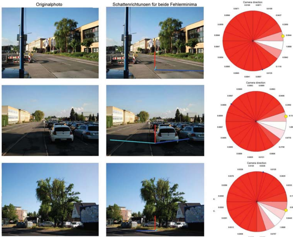
Abbildung 17: Schätzung des Azimutwinkels der Kamera: In der mittleren Spalte sind die zu den Fehlerminima gehörigen Schatten eingezeichnet. Ein blauer Schatten kennzeichnet das globale Minimum. Ein cyan-farbener Schatten das zweite beste lokale Minimum.
