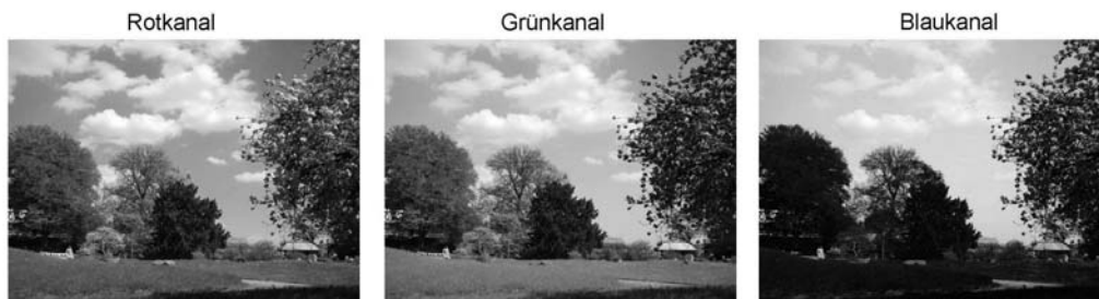
Abbildung 4: Die verschiedenen Kanäle eines Bildes im RGB-Farbraum.
