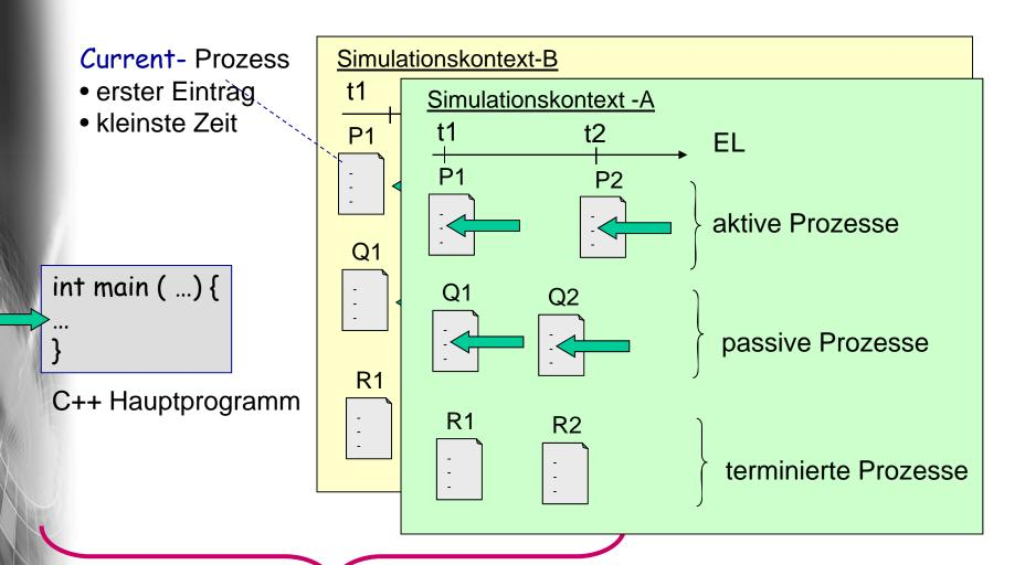
Hauptprogramm und Prozesse aller Simulationskontexte bilden ein hierarchisches Coroutinensystem
