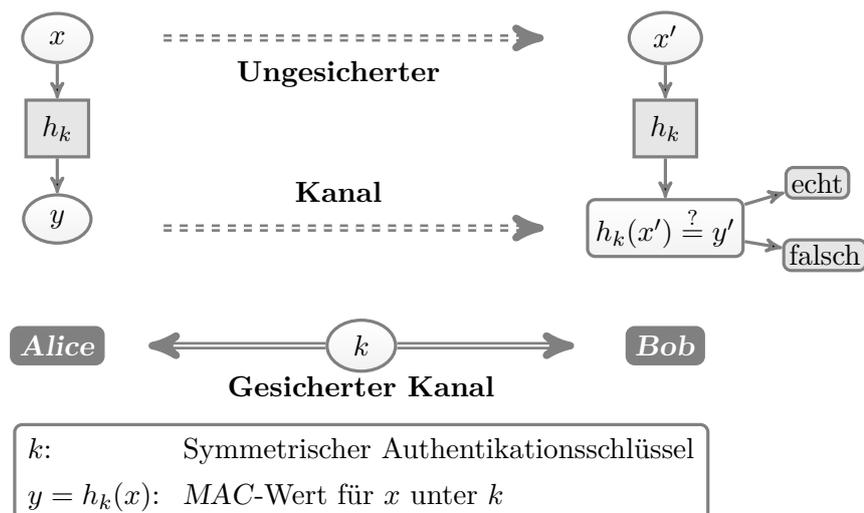
Abbildung 1.3: Verwendung eines MAC zur Nachrichtenauthentikation.
