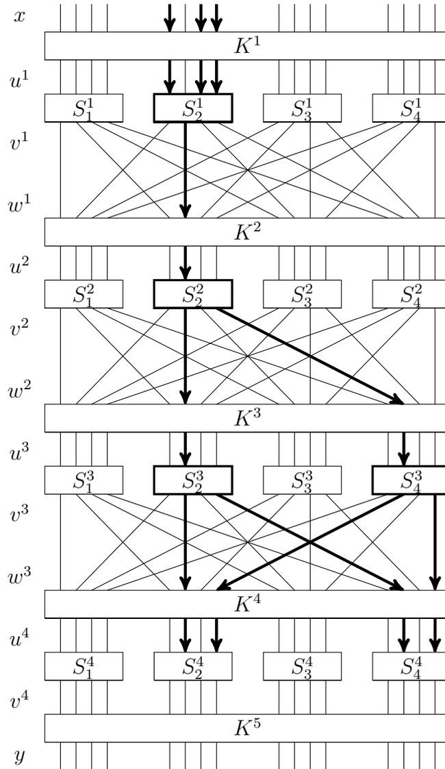
Abbildung 4.2: Eine lineare Approximation an ein Substitutions-Permutations-Netzwerk.
