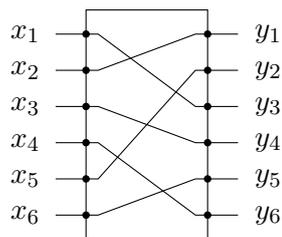
Die Implementierung einer solchen P-Box kann beispielsweise auf einem VLSI-Chip erfolgen. Allerdings kann hierbei für größere Werte von  $l$  aufgrund der hohen Zahl von Überkreuzungspunkten ein hoher Flächenbedarf anfallen.
