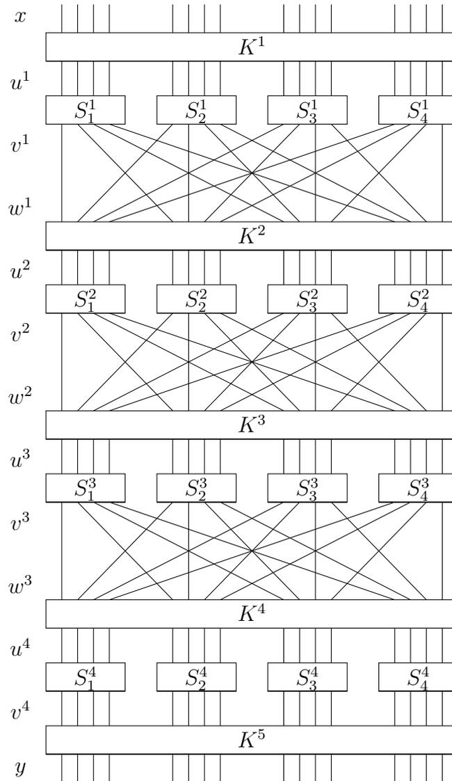
Abbildung 4.1: Ein Substitutions-Permutations-Netzwerk.
