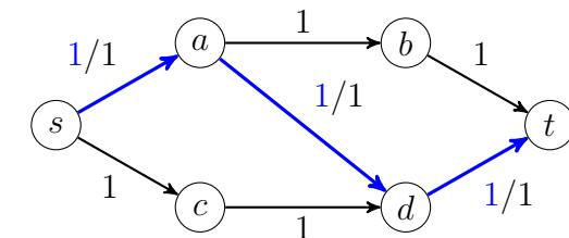
Ein blockierender Fluss muss also nicht unbedingt maximal sein. Tatsächlich ist  $g$  genau dann ein blockierender Fluss in  $N$ , wenn es im Restnetzwerk  $N_g$  keinen Zunahmepfad gibt, der nur aus Vorwärtskanten  $e \in E$  mit  $g(e) < c(e)$  besteht. Wir werden sehen, dass sich ein blockierender Fluss in Zeit  $O(n^2)$  berechnen lässt.
