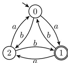
Der Startzustand wird meist durch einen Pfeil und Endzustände werden durch einen doppelten Kreis gekennzeichnet. ◁
