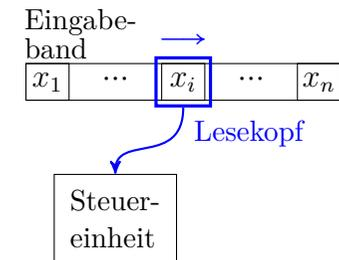
**Definition 4.** Ein **endlicher Automat** (kurz: DFA; deterministic finite automaton) wird durch ein 5-Tupel  $M = (Z, \Sigma, \delta, q_0, E)$  beschrieben, wobei
