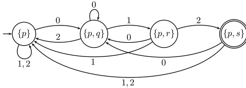
Im obigen Beispiel wurden für die Konstruktion des DFA  $M$  aus dem NFA  $N$  nur 4 der insgesamt  $2^{|\Sigma|} = 16$  Zustände benötigt, da die übrigen 12 Zustände in  $\mathcal{P}(Z)$  nicht vom Startzustand  $Q_0 = \{p\}$  aus erreichbar sind. Es gibt jedoch Beispiele, bei denen alle  $2^{|\Sigma|}$  Zustände in  $\mathcal{P}(Z)$  für die Konstruktion des so genannten **Potenzmengenautomaten**  $M$  benötigt werden (siehe Übungen).
