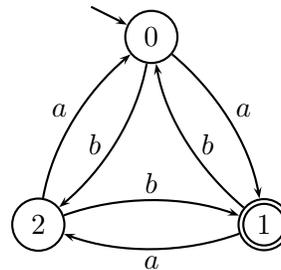
Der Startzustand wird meist durch einen Pfeil und Endzustände werden durch einen doppelten Kreis gekennzeichnet.
