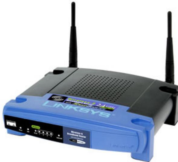
Der Linksys Wireless LAN Router bildet die Hardware-Plattform für das Berlin Roof Net Projekt.
