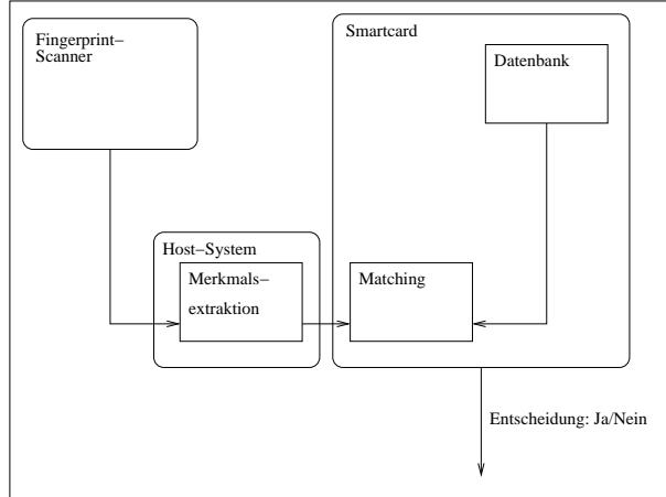
Abbildung 1.6: Aufbau eines MOC-Systems
