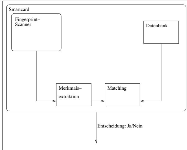
Abbildung 1.7: Aufbau eines SOC-Systems
