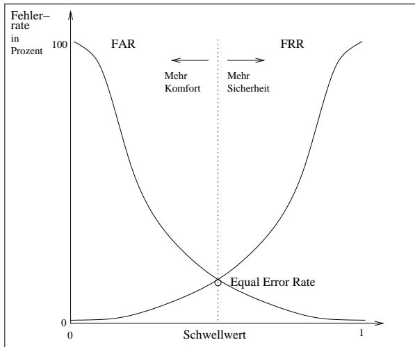
Abbildung 1.4: Typische Fehlerkurve bei biometrischen Verfahren (Quelle [6])
