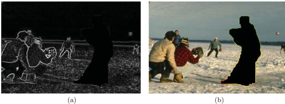
Abbildung 4.3.: Beispiel zur Initialisierung: (a) Visualisierung des Betrags der Gradienten (maskiert) (b) errechnete Füllpriorität, visualisiert als farbige Linie um den maskierten Bereich (rot = hohe Priorität, grün = niedrige Priorität)
