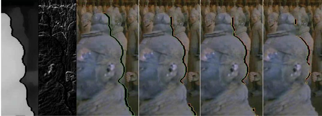
Abbildung 4.10.: Darstellung der Prioritätsberechnung. Von links nach rechts: Tiefenkarte, Gradientenbeträge, Prioritäten bei Iteration 0, 35, 49 und 85 sowie ansteigend von grün nach rot. Erläuterungen im Text.
