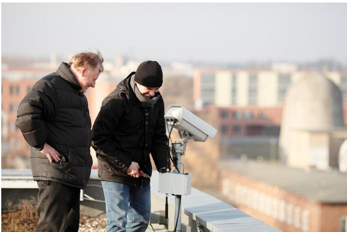
Ziel der Aktivitäten in diesem Jahr war es, das *outdoor*-Netzwerk auszubauen. Dabei wurden SOSEWIN-Knoten der 2. Generation mit wasserfestem Außengehäuse, zwei drahtlosen Netzwerkschnittstellen und 3-Achsen Beschleunigungssensoren verwendet. Um die Knoten auf Dächern verschiedener Institute und Forschungseinrichtungen, wie z.B. HU Physik, HU Geographie, DLR, FH First, und Verwaltungseinrichtungen, wie HU CMS oder Wista Adlershof zu installieren, mussten administrative und technische Prob-
