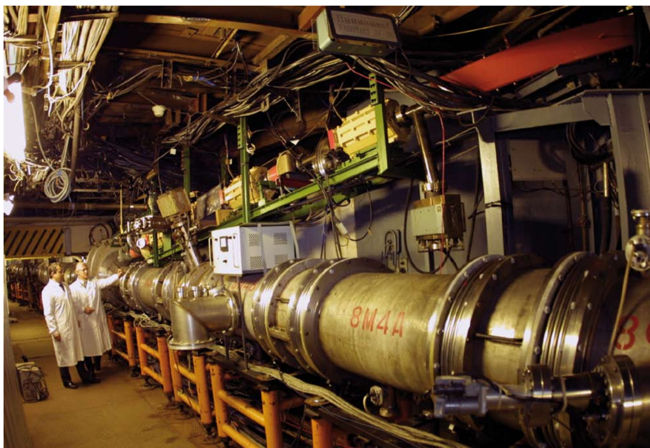
Das Nuklotron – eine supraleitende Anlage zur Beschleunigung von Kernen und schweren Ionen.
