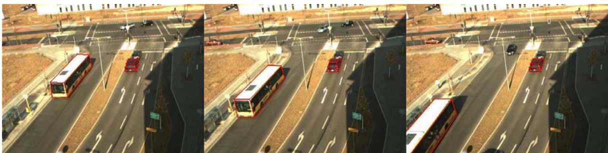
Abb: Fahrzeugtyp „Bus“ in einer Bildsequenz erkannt
