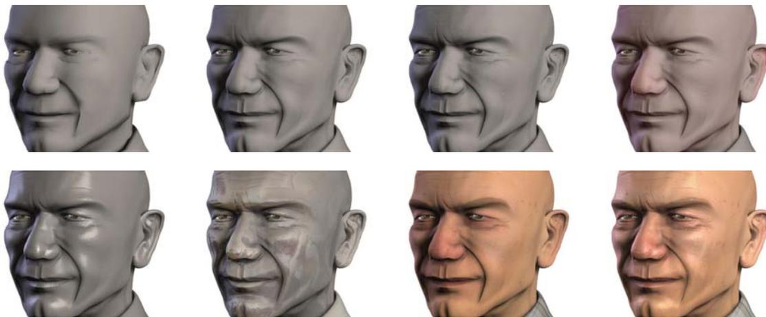
**Abbildung 4-8: Angewendete Texturen:** Ausgangsgeometrie, Displacementmap, Bumpmap, Subsurface Scattering, Specular, Colormap und finales Rendering mit allen Texturen.
