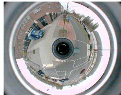
Für die automatisierte Verkehrserfassung bieten sich neben klassischen Kameras auch andere Projektionsgeometrien an. Ein gutes Beispiel dafür sind katadioptrische Kameras. In der Regel bestehen solche Systeme aus einer Kombination von Kamera und konvexem Spiegel. Sie liefern zylindrische Panoramen und ermöglichen dabei ein vertikales Sichtfeld von mehr als 180°.
