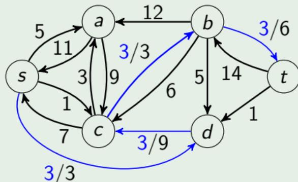
Durch Addition der beiden Flüsse  $f$  und  $f_P$  erhalten wir einen Fluss  $f' = f + f_P$  in  $N$  der Größe  $|f'| = |f| + |f_P| = |f| + c_f(P) > |f|$
