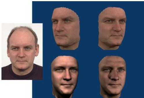
In der nächsten Phase des Projektes soll die Anzahl der Kameras reduziert werden, ohne dass die Qualität der Animation abnimmt. Dazu müssen aus den aufgenommenen Bildern Zwischenbilder im Computer generiert werden. Hierfür muss die dreidimensionale Form des Kopfes näherungsweise bestimmt werden. Eine besondere Herausforderung stellt hierbei die realistische Wiedergabe von Haaren in den generierten Zwischenbildern dar. Hierfür werden bildbasierte Darstellungsverfahren
