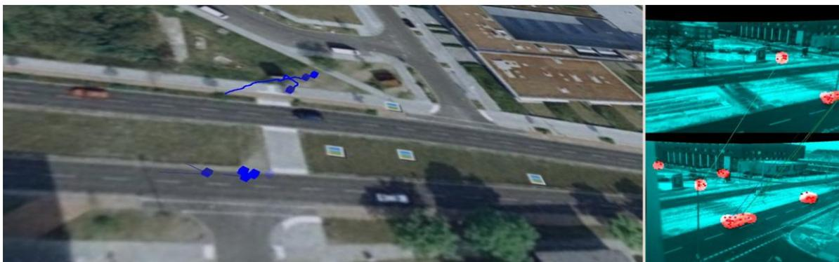
Abbildung 3: Zwei Ansichten einer Kreuzung mit einer großen Stereo-Basis (rechte Seite). Auf der linken Seite ist die Rekonstruktionsansicht dargestellt, mit einer 3D-Rekonstruktion von Features der beiden Eingangsbilder. Außerdem sieht man die Trajektorie eines Fußgängers.
