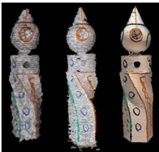
Abbildung 1: Rekonstruierte Daten der verschiedenen Aufnahmesysteme des Testkörpers.
