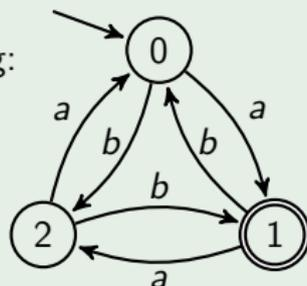
Endzustände werden durch einen doppelten Kreis und der Startzustand wird durch einen Pfeil gekennzeichnet
