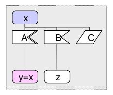
notwendig für Spezialfall: Folgezustand *y* für priorisierten A-Trigger ist wieder Ausgangszustand *x*
