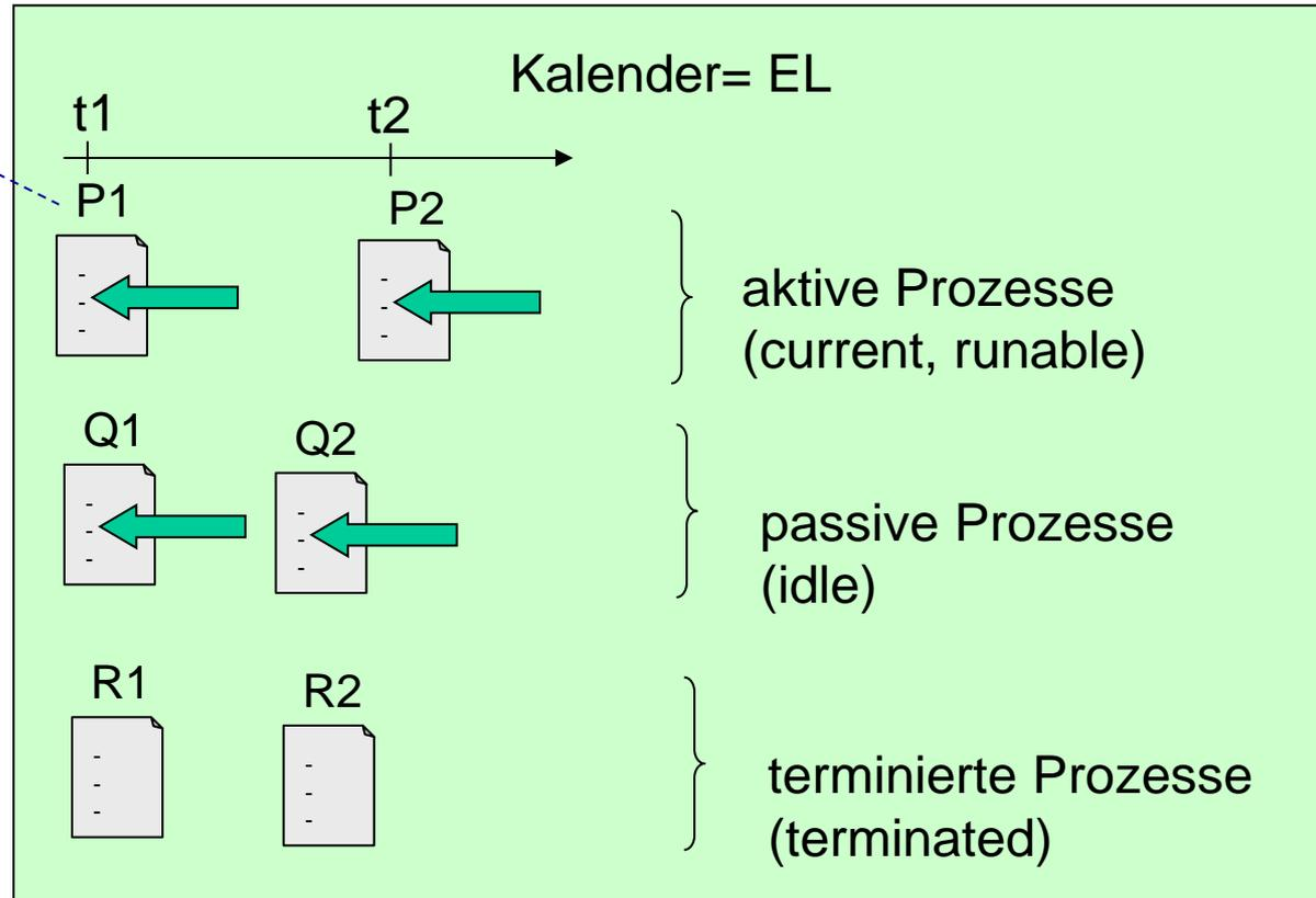
Ensemble von **main()**-Funktionen aller existenten Prozess-Objekte wird zusammen mit eigentlichem C++ Hauptprogramm als Ensemble von Coroutinen quasiparallel ausgeführt
