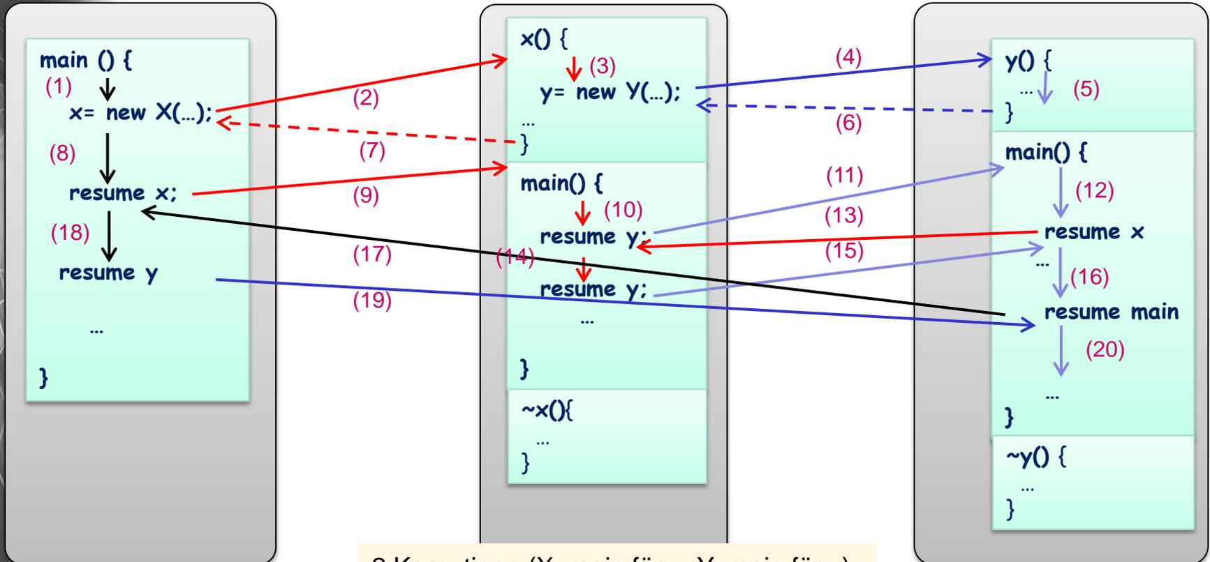
2 Koroutinen (X::main für x, Y::main für y) plus ausgezeichnete Koroutine ::main
