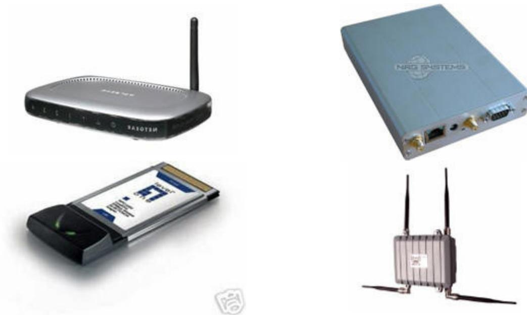
Abbildung 4: Vom BRN zur Zeit unterstützte Embedded Devices (Netgear 643u, WRAP Board, Atheros-based PCMCIA, Soekris Board).
