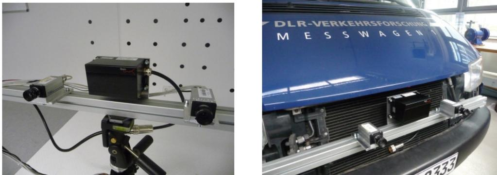
Abb. 7: Stereosystem und Laserscanner im Labor (links) und am Testfahrzeug (rechts).
