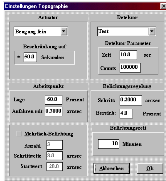
Abbildung 3.4: Dialogfenster zum Einstellen der Topographieparameter
